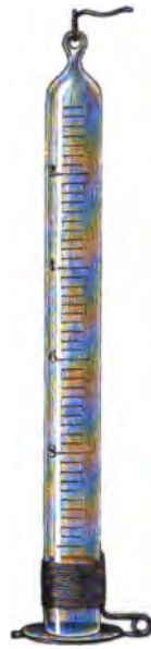
Fig. 64. — Atmomètre pour contrôler la dessiccation de l'argile.
